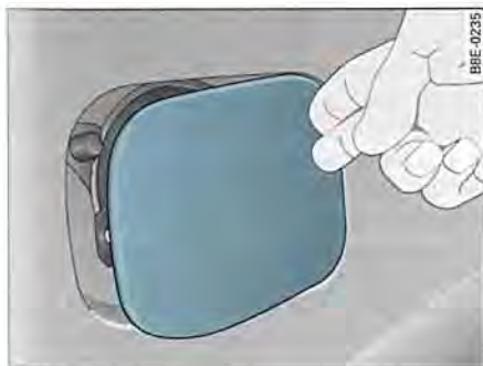
Fig. 207 Lado trasero derecho del vehículo: Apertura de la tapa del depósito
