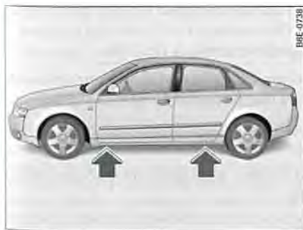
Fig. 234 Cambio de rueda: Puntos de apoyo del gato
