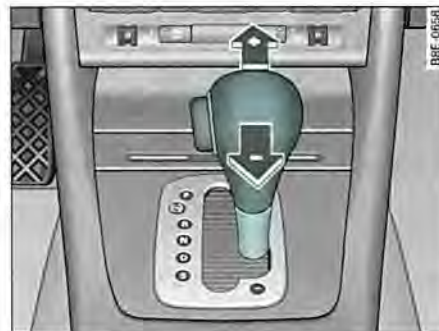
Fig. 147 Consola central: Cambiar las marchas manualmente (tiptronic)
