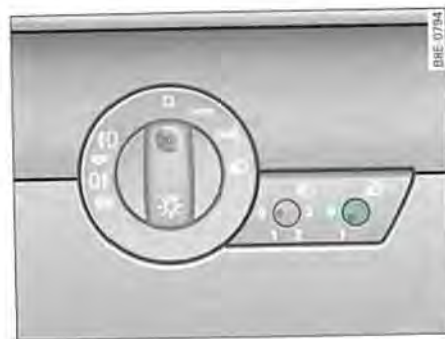
Fig. 64 Detalle del tablero de instrumentos: Funciones coming home y leaving home
