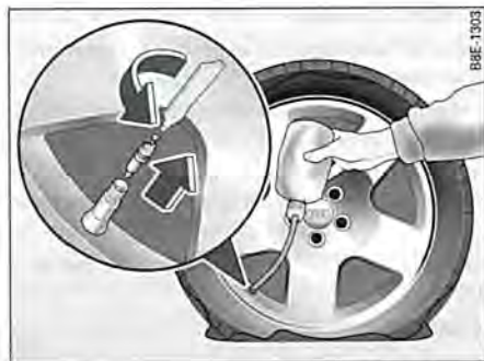
Fig. 240 Efectuar la reparación
