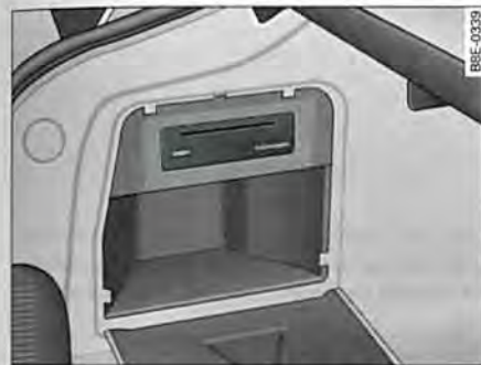
Fig. 103 Maletero: Lector de CD-ROM para el sistema de navega- ción
