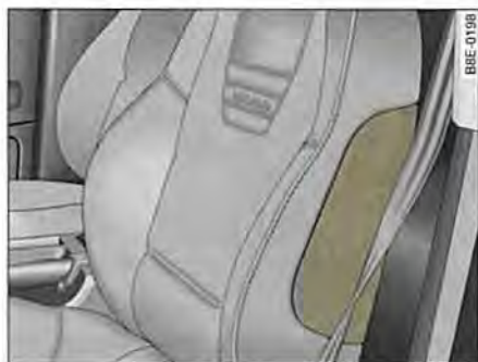
Fig. 177 Lugar de montaje del airbag lateral en el asiento del conductor
