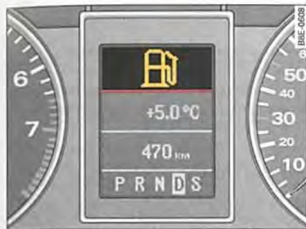
Fig. 17 Pantalla: Nivel de combustible bajo
