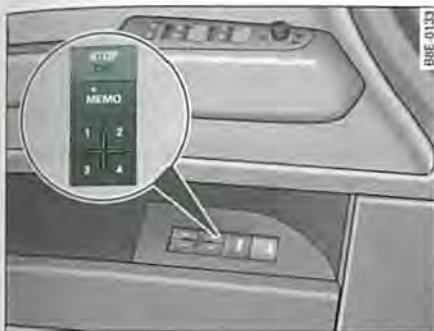
Fig. 91 Puerta del conductor: Sistema de memoria
