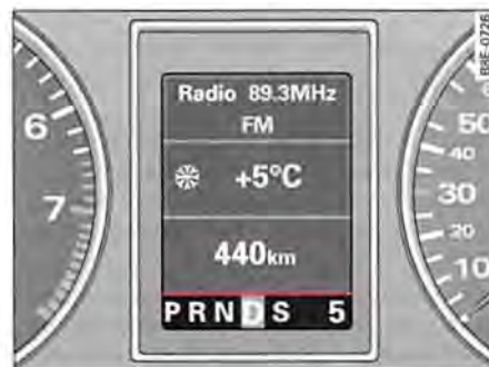
Fig. 145 Pantalla: Posiciones de la palanca selectora
