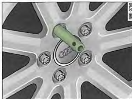
Fig. 237 Cambio de rueda: Pasador de montaje en el agujero superior
