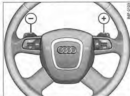
Fig. 149 Volante: Mandos del tiptronic
