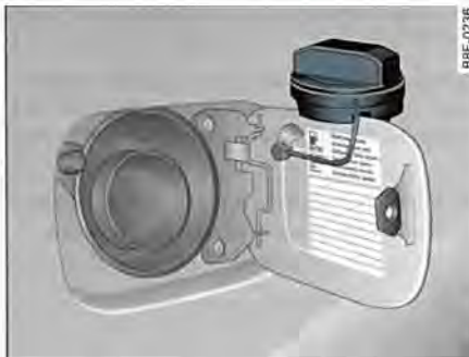
Fig. 208 Tapa del depósito con el tapón encajado
