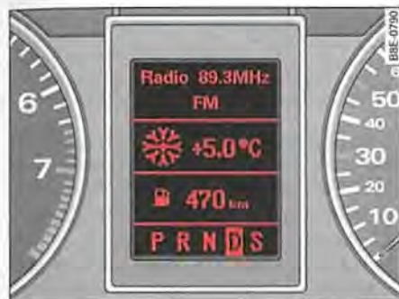
Fig. 9 Puesto de conducción: Pantalla digital del cuadro de instrumentos
