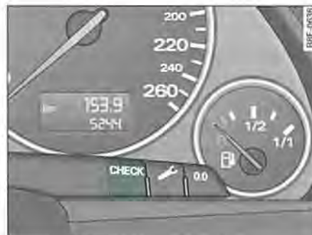
Fig. 6 Detalle del cuadro de instrumentos: Tecla CHECK
