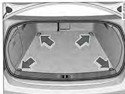
Fig. 97 Disposición de las argollas de amarre en el maletero
