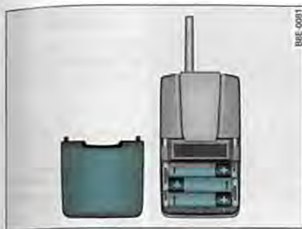
Fig. 134 Control remoto para calefacción / ventilación estacionaria, cambio de batería
