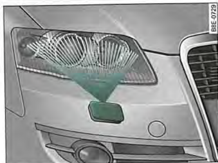
Fig. 80 Faro con inyector de lavado desplegado
