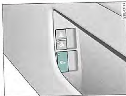
Fig. 51 Puerta del conductor: Desbloquear el portón trasero
