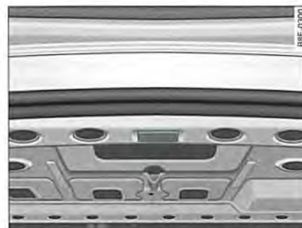
Fig. 74 Detalle de la parte superior del maletero: Iluminación del maletero
