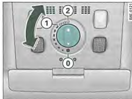
Fig. 59 Detalle del revestimiento del techo: Mando giratorio para el techo corredizo/deflector
