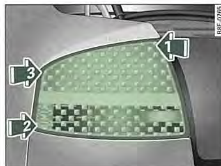
Fig. 261 Montar la unidad de luz trasera
