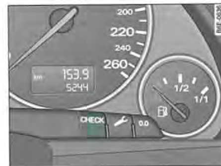
Fig. 20 Detalle del cuadro de instrumentos: Tecla CHECK
