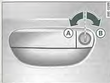
Fig. 47 Movimientos de la llave para abrir y cerrar
