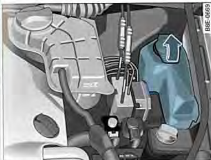
Fig. 220 Compartimento del motor: Depósito del sistema lavacristales
