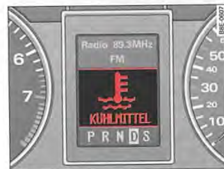
Fig. 16 Pantalla: Aviso sobre el nivel del líquido refrigerante
