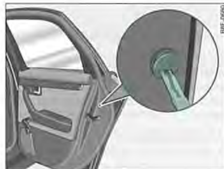
Fig. 49 Dispositivo de bloqueo de emergencia ►
