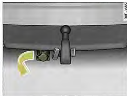
Fig. 202 Parachoques trasero: Pivotar hacia abajo la toma de corriente para el remolque
