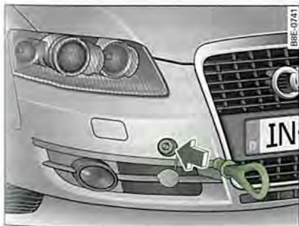
Fig. 243 Parachoques delantero: Argolla de remolque enroscada
