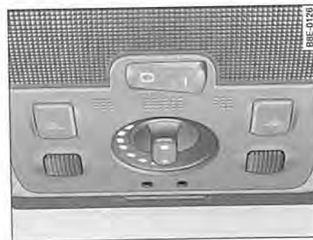
Fig. 72 Detalle del revestimiento del techo: Iluminación ambiental
