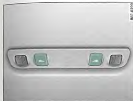
Fig. 73 Detalle del revestimiento del techo: Luces de lectura traseras
