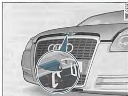
Fig. 211 Tirador de apertura por debajo del capó
