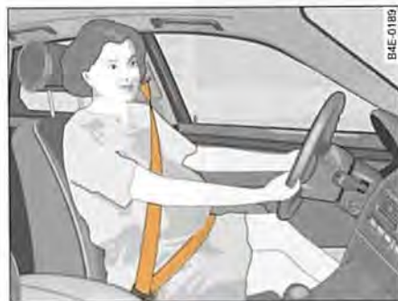
Fig. 170 Colocación de la banda del cinturón en el caso de mujeres embarazadas
