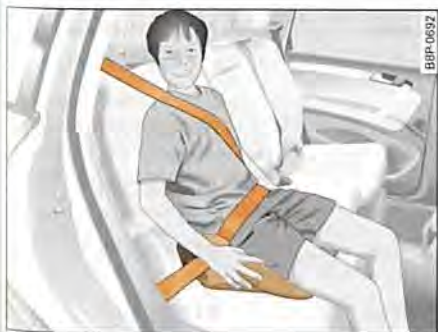
Fig. 188 Asiento para niños del grupo 2/3 (con respaldo) montado en el asiento trasero en la dirección de marcha.
