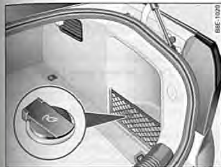
Fig. 116 Detalle del revestimiento lateral del maletero: Toma de corriente de 12 voltios
