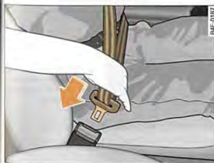
Fig. 168 Asiento del conductor: cierre y lengüeta de cierre del cinturón
