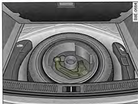
Fig. 194 Maletero: Rueda de repuesto con dispositivo para remolque
