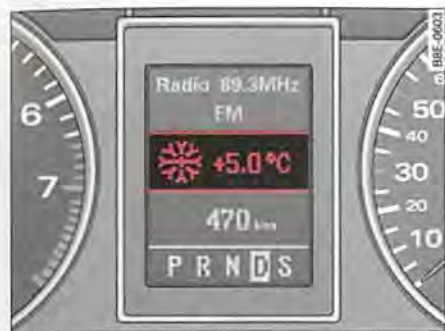
Fig. 11 Pantalla: Indicador de temperatura exterior
