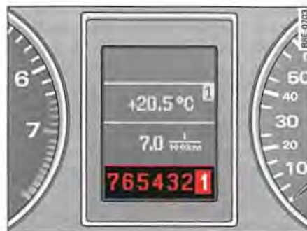
Fig. 154 Pantalla: Cambiar las marchas manualmente (tiptronic)
