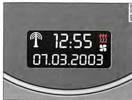
Fig. 131 Puesto de conducción: Display del reloj digital, temporizador activado
