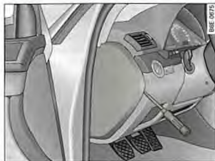
Fig. 244 Panel lateral izquierdo del tablero de instrumentos: Tapa de los fusibles
