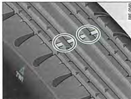
Fig. 222 Dibujo del neumático: Indicadores de desgaste
