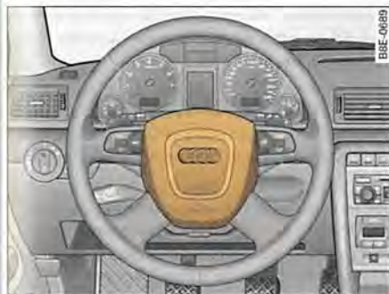
Fig. 173 Airbag del conductor en el volante
