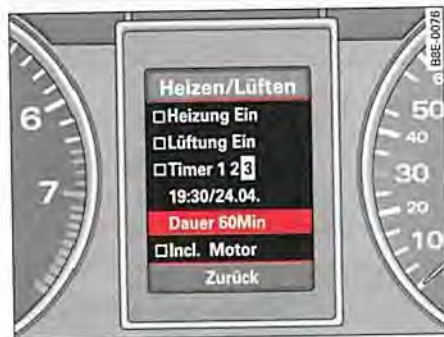
Fig. 129 Puesto de conducción: Pantalla del FIS, menú Heizen/Lüften (Calentar/ventilar), se ha seleccionado la duración de funcionamiento del temporizador 3
