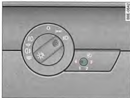
Fig. 66 Regulación del alcance de las luces
