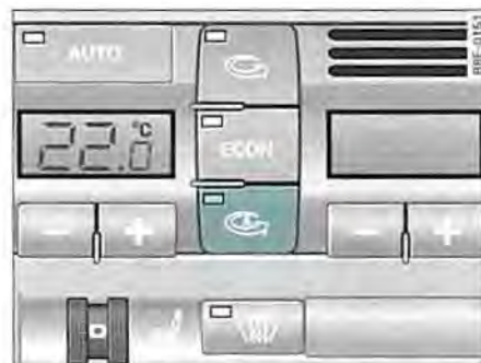
Fig. 123 Tecla para la recirculación de aire automática
