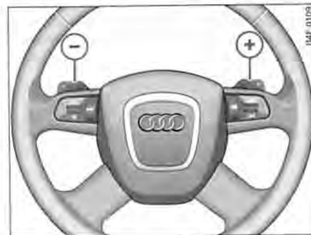
Fig. 155 Volante: Mandos del tiptronic
