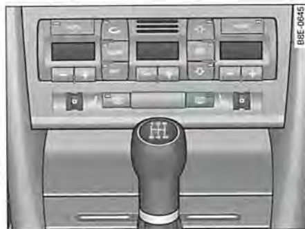
Fig. 75 Interruptor para luneta térmica
