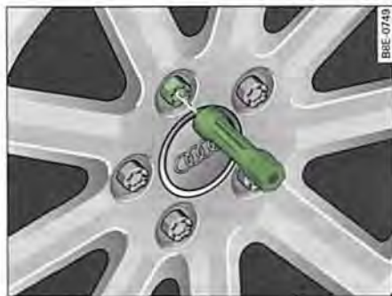
Fig. 236 Cambio de rueda: Útil de hexágono interior para girar los tornillos
