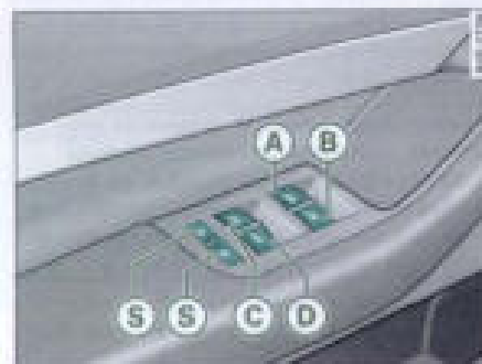
Fig. 53 Detalle de la puerta del conductor. Mandos en vehículos con seguro para niños de mando eléctrico
