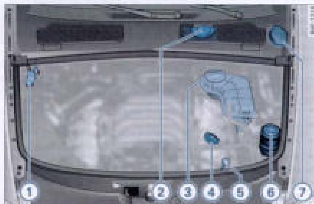
Fig. 283 Disposición típica de los depósitos, de la varilla de medición de aceite y de la boca de llenado de aceite del motor
