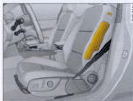
Fig. 250 Lugar de montaje del airbag lateral en el asiento del conductor
