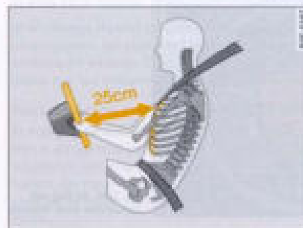
Fig. 249 Distancia de seguridad respecto al volante
