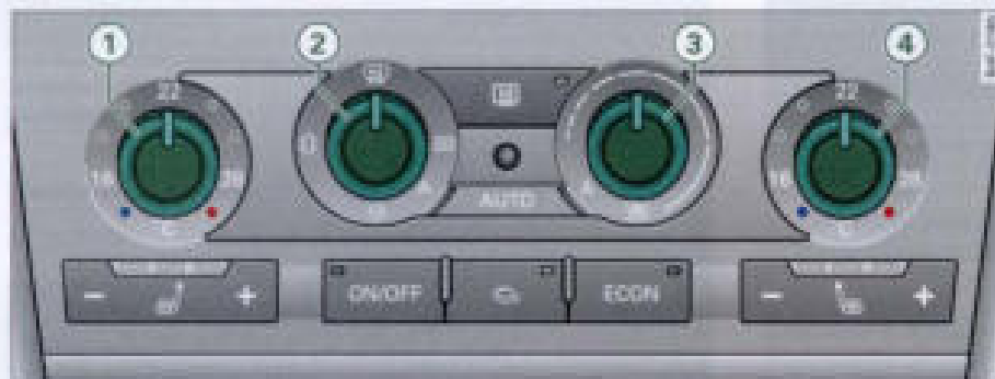
Fig. 131 Mandos del climatizador automático de confort
