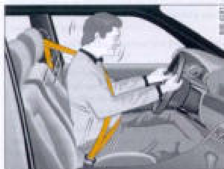
Fig. 235 Un cinturón de seguridad bien puesto sujetará al conductor en caso de frenazo repentino.
