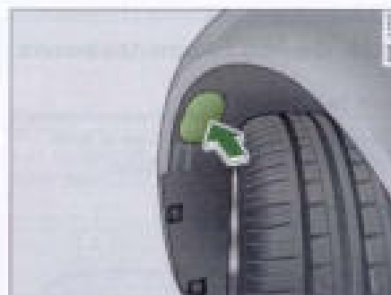
Fig. 332. Guardabarros delantero: Montar la cubierta
