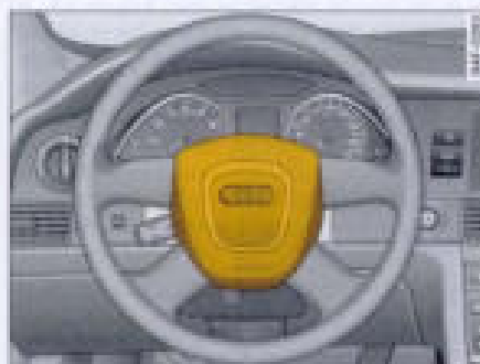
Fig. 246 Airbag del conductor en el volante
