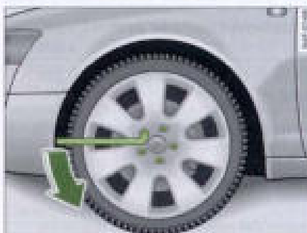
Fig. 309 Cambio de rueda: Aflojar los tornillos de la rueda
