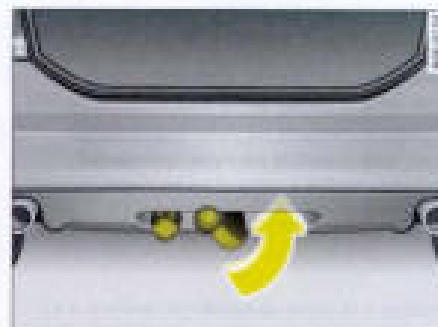
Fig. 275 Parachoques trasero: Volver a colocar en su posición, pivotando, el dispositivo para remolque
