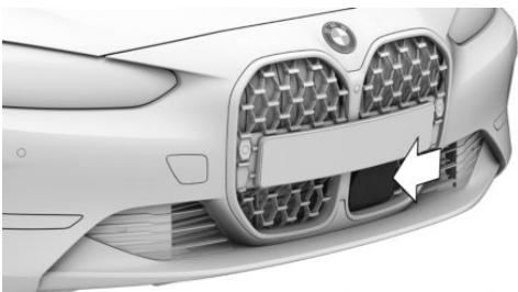
Parachoques delantero. Mantener los sensores de radar limpios y sin obstáculos.
