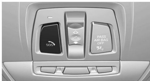
Tecla SOS en el techo.
