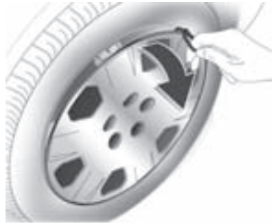
1. Desenclave los tapones de las tuercas de rueda con un destorni-
