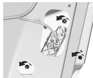
1. Extraiga ambos pasadores usando un destornillador y abra el tapizado.
