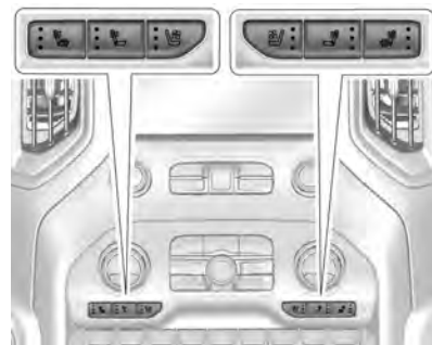
Se muestran los botones del asiento con calefacción y ventilación, botones del asiento con calefacción similares
