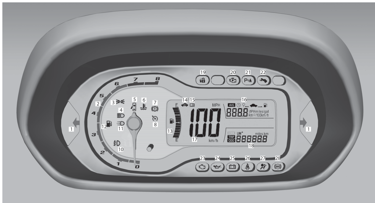
Indicadores de control del tablero de instrumentos (modelo A) – Para motores de gasolina y combustible flexible
