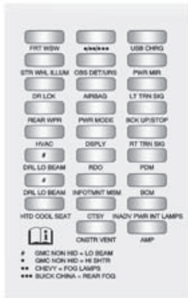
Lado de fusibles
