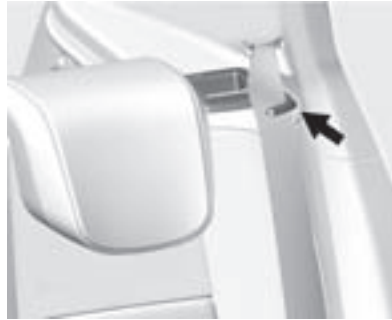
Asiento trasero con gacho de retención en el Respaldo del asiento.
