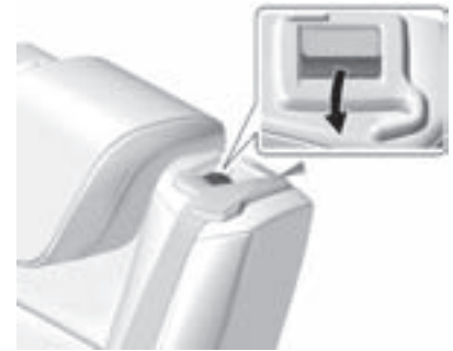
Asiento trasero con gacho de retención en el Respaldo del asiento.
