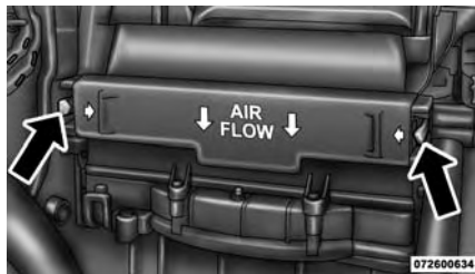
Reemplazo del Filtro del purificador del aire acondicionado
