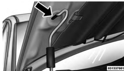
Emplazamiento de Barra de soporte
