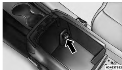
Enchufe de tensión de la consola central
