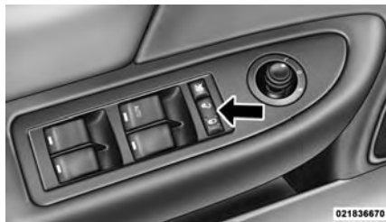
Switch de seguro eléctrico de las puertas
