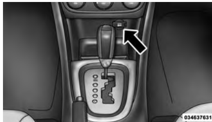
Enchufe de tensión del panel de instrumentos
