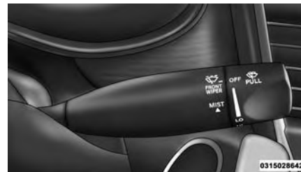
Operación del lavaparabrisas
