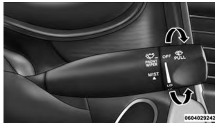
Funcionamiento del limpiaparabrisas intermitente
