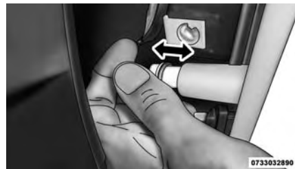
Extracción de la bombilla de la lámpara de posición lateral delantera
