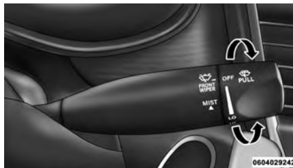
Funcionamiento del limpiaparabrisas
