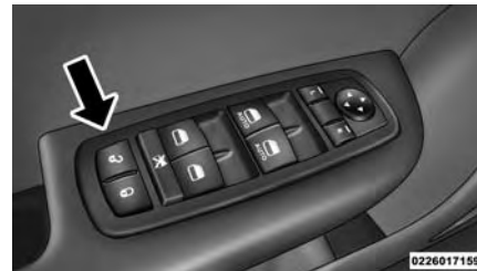
Switches de los seguros eléctricos de las puertas
