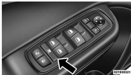
Switch de desactivación de ventanas
