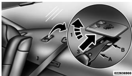
Montaje de la correa del anclaje
