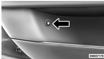
Switch de desenganche de la puerta de la boca de llenado de combustible
