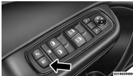
Switch de bloqueo eléctrico de la puerta
