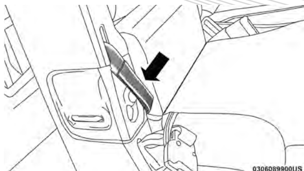
Correa de la segunda fila de asientos para doblar el octavo asiento
