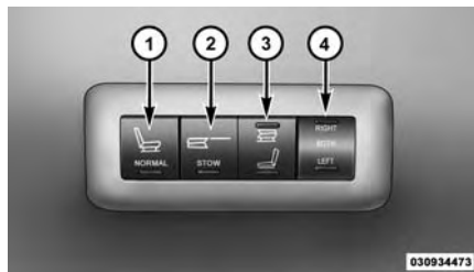
Banco de switches eléctrico en el panel trasero
