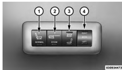
Banco de interruptores eléctricos del panel trasero
