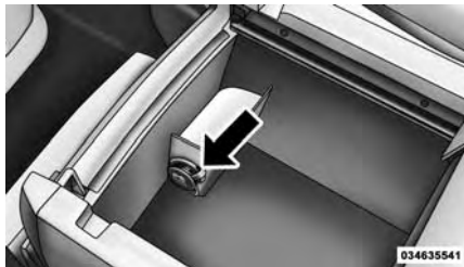
Ubicación de la toma de corriente de la consola del piso
