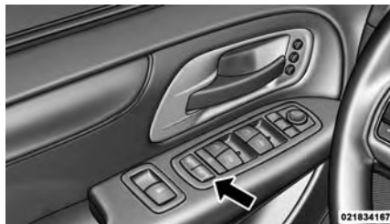
Interruptores de bloqueo eléctrico de la puerta del conductor
