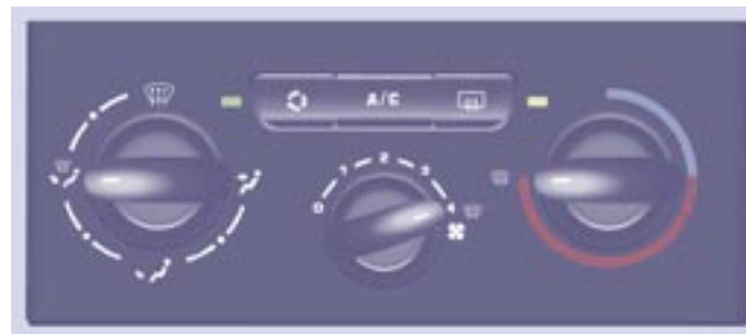
Frontal del aire acondicionado
