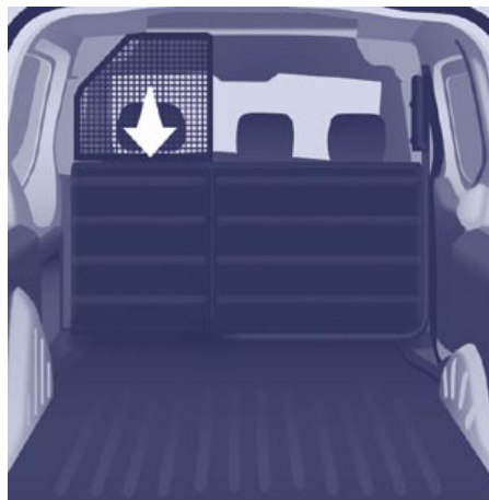
Tabique media altura
