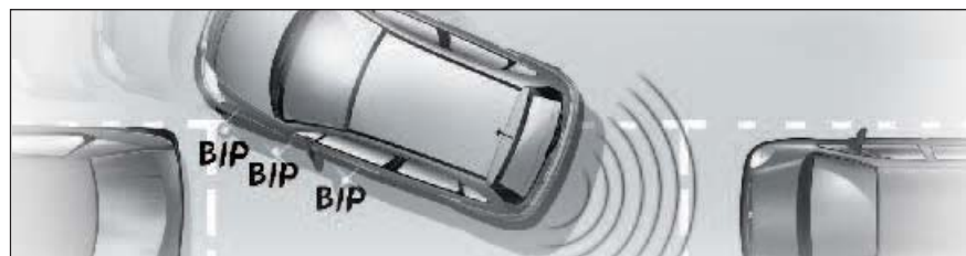
Zona de detección
