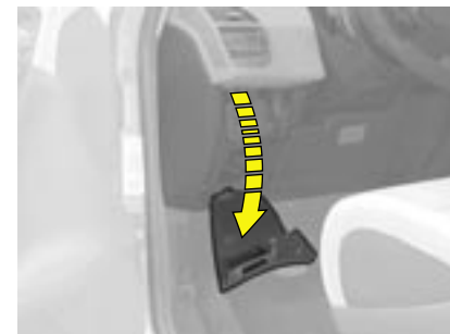
Acceso a la primera caja de fusibles bajo la plancha de a bordo
