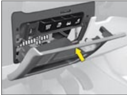
Caja de fusibles
