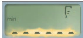
Falta de aceite = Parpadeo de los segmentos
