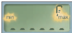
Un parpadeo indica incidente de funcionamiento del indicador o falta de aceite.
