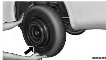
Montaje de la goma de repuesto
