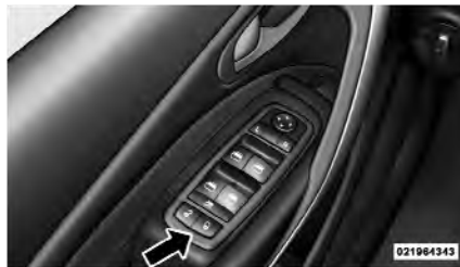
Switch de seguro eléctrico de las puertas
