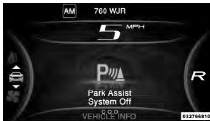
Sistema de asistencia para parqueo desactivado
