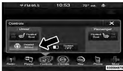
Tecla virtual del volante de dirección térmico
