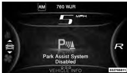
Sistema de asistencia para parqueo desactivado
