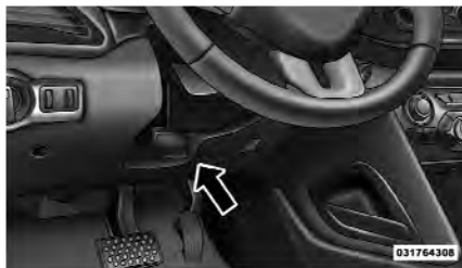
Manija de control de la columna inclinable y telescópica
