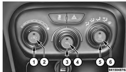
Botones de control de climatización manual
