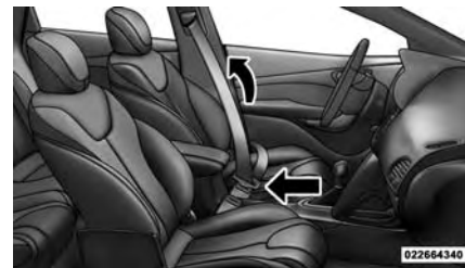
Colocación del cinturón de cadera
