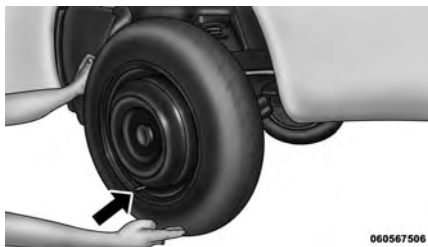
Montaje de la goma de repuesto
