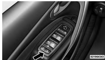
Switch de bloqueo eléctrico de la puerta
