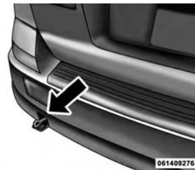
Anilla para remolque trasera instalada
