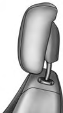
Apoyacabezas activo (posición normal)
