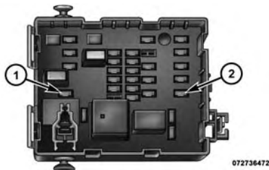
Fusibles de la toma de corriente
