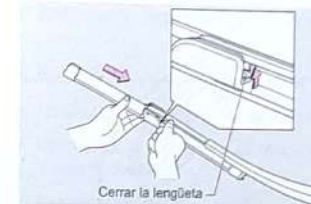
2. Retire el conjunto de la cuchilla al brazo del limpiador.
