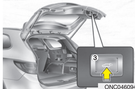
(2) Interruptor de la empuñadura del portón eléctrico
