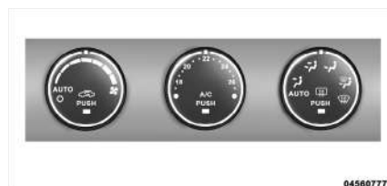
Control automático de temperatura
