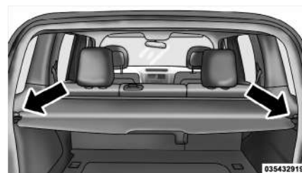
Colocación de la cubierta de zona de carga retráctil
