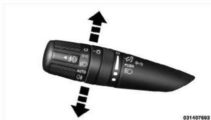
Control de intermitentes
