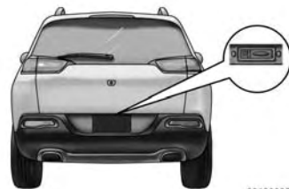
Ubicación de la apertura electrónica de la puerta trasera/acceso pasivo de la puerta trasera
