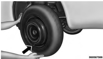
Montaje del neumático de repuesto
