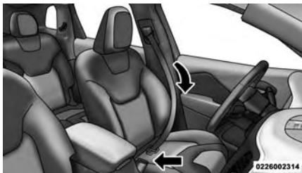
Extracción de la placa de cierre
