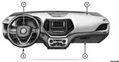
Ubicaciones del airbag delantero avanzado y del protector de rodillas
