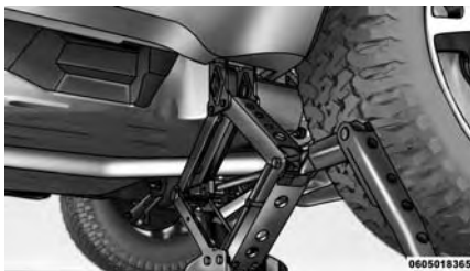
Posición trasera de elevación con gato
