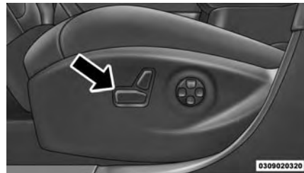
Interruptor del asiento eléctrico
