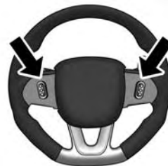
Controles remotos del sistema de sonido (Vista trasera del volante)
