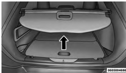
Cubierta del área de carga retráctil
