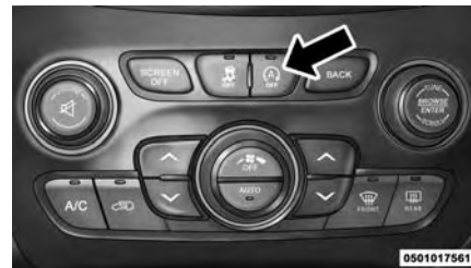
Interruptor OFF (Apagado) del sistema de Detención/Arranque
