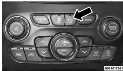
Interruptor OFF (Apagado) del sistema de Detención/Arranque
