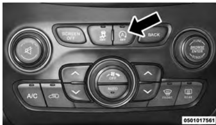
Interruptor OFF (Apagado) del sistema de Detención/Arranque
