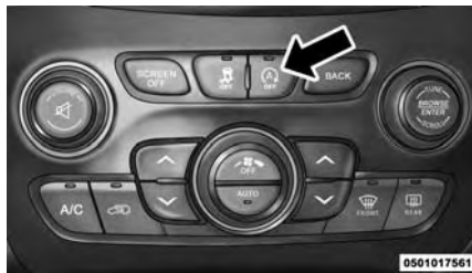
Interruptor OFF (Apagado) del sistema de Detención/Arranque
