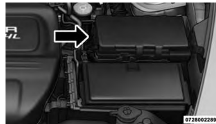
Centro de distribución de energía
