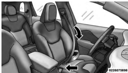
Extracción de la placa de cierre
