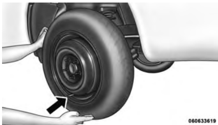
Instalación del neumático de repuesto
