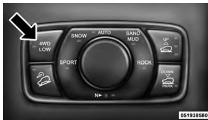
Interruptor de la caja de transferencia
