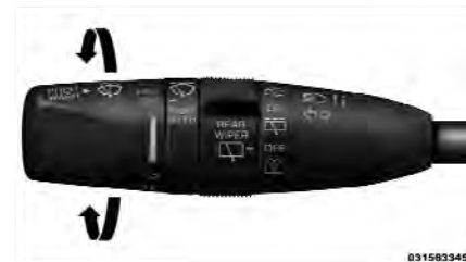
Funcionamiento del limpiaparabrisas
