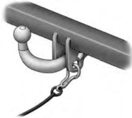
Método de engarce de sujeción de bola fija
