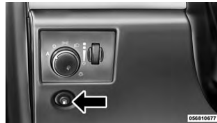
Interruptor de apertura de la puerta del depósito de combustible
