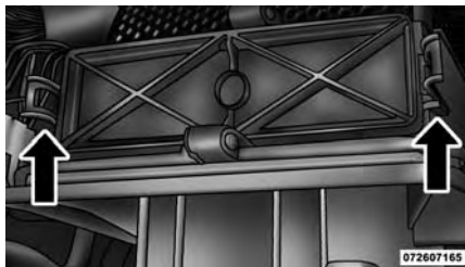
Sustitución del filtro de aire del A/A
