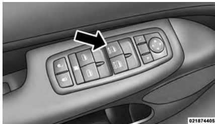
Interruptores de las ventanas con ascenso automático
