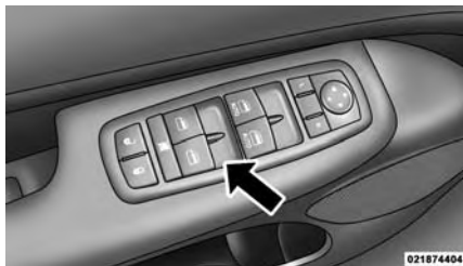
Interruptores de las ventanas eléctricas
