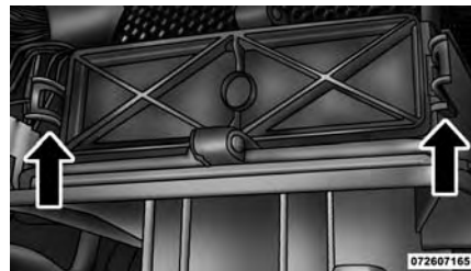
Cambio del filtro de aire del A/A
