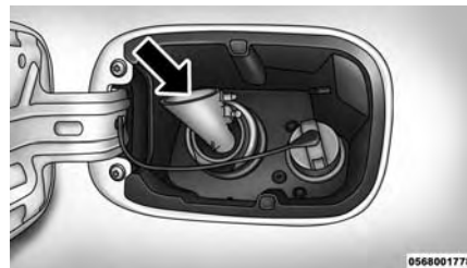
Ubicación de llenado de combustible de emergencia
