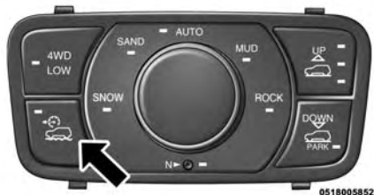
Interruptor del control de selección de velocidades
