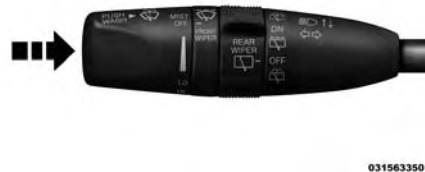
Funcionamiento del lavaparabrisas
