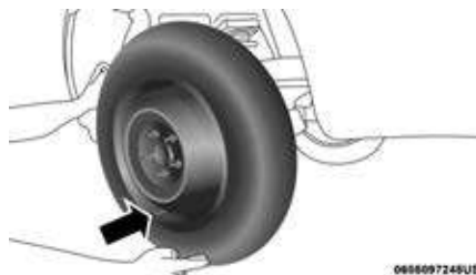
Montaje del neumático de repuesto
