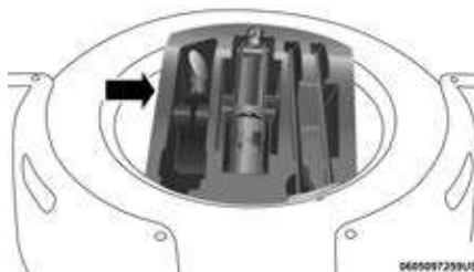
Ubicación del embudo de llenado de combustible
