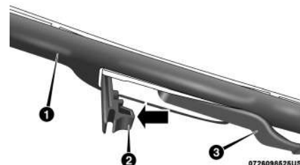
Plumilla del limpiador con pestaña de liberación en posición desbloqueada
