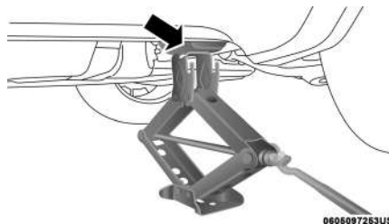
Posición trasera de elevación con gato
