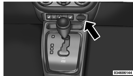
Toma de corriente de 12 voltios
