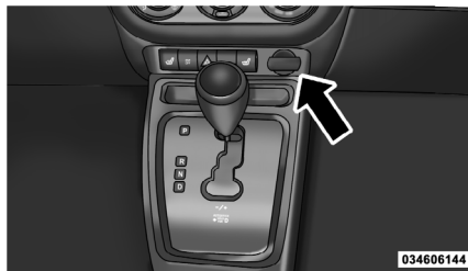
Toma de corriente de 12 voltios
