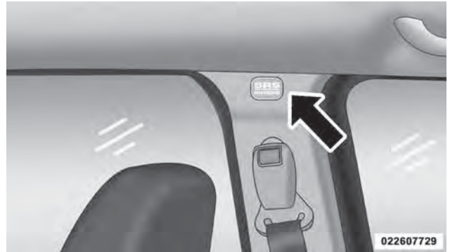
Ubicación de las cortinas inflables complementarias de las bolsas de aire laterales (SABIC)
