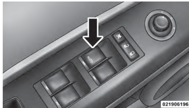
Localización de los interruptores eléctricos
