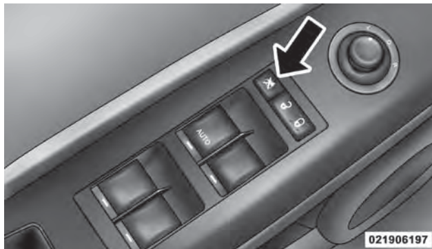
Interruptor de seguro de ventanillas
