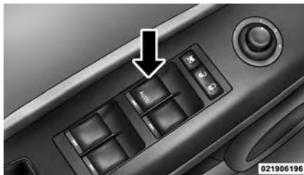
Ubicación del interruptor de las ventanas eléctricas
