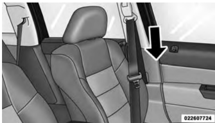
Extracción de la placa de cierre
