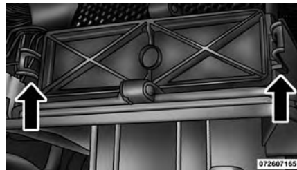
Cambio del filtro de aire del A/A
