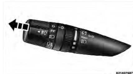
Funcionamiento de las luces antiniebla
