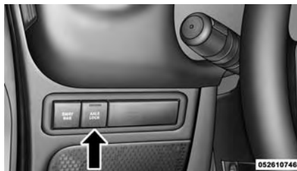
Interruptor de bloqueo de eje
