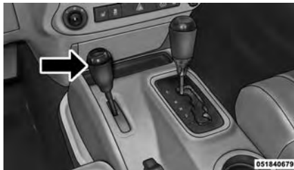
Controles de cambio para vehículos con tracción en las cuatro ruedas
