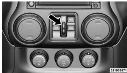
Interruptor de bloqueo de las ventanas
