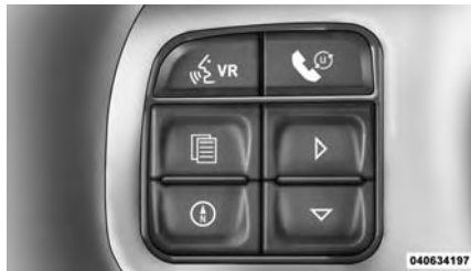
Botones del centro electrónico de información del vehículo (EVIC)
