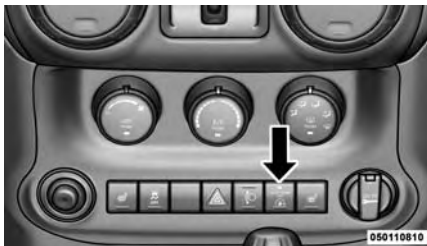
Interruptor DETENCIÓN/ARRANQUE apagado
