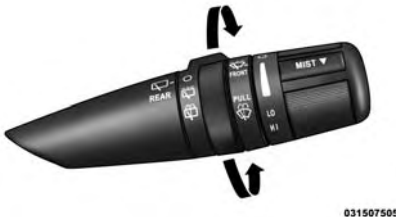
Control del limpiador y lavador trasero
