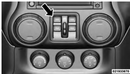
Interruptores de las ventanas eléctricas
