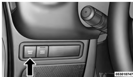
Interruptor de la barra estabilizadora
