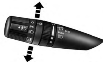
Funcionamiento del señalizador de dirección
