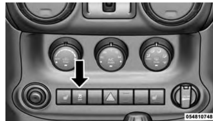
Interruptor ESC desactivado
