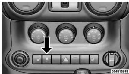
Interruptor ESC desactivado
