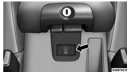
Inversor de corriente
