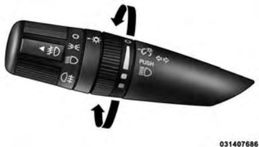
Control de atenuación
