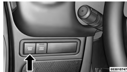
Interruptor de la barra estabilizadora
