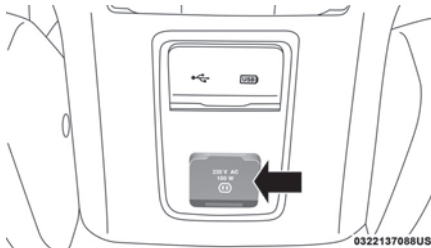
Inversor de corriente
