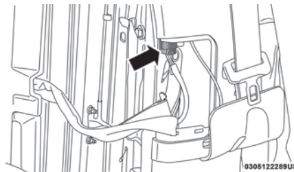
Conector del cableado
