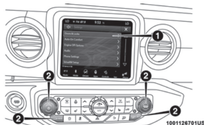
Pantalla táctil y botones de la placa frontal de Uconnect 4C/4C NAV
