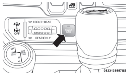
Interruptor de la barra estabilizadora
