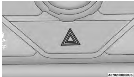
Interruptor de las luces de emergencia
