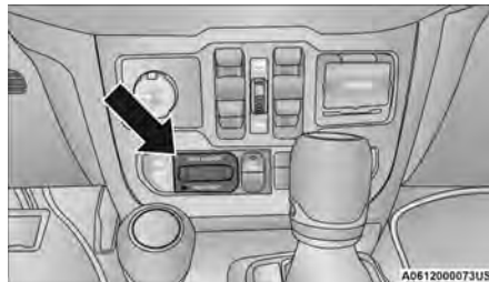
Panel de interruptores de bloqueo de ejes
