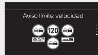
■ Pantalla del tablero de ISLW
