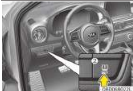
Indicador de presión baja de los neumáticos (1) / Interruptor TPMS SET (2)
