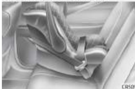
Sistema de sujeción del niño en dirección contraria al sentido de la marcha
