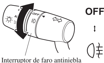
Interruptor de faro antiniebla
