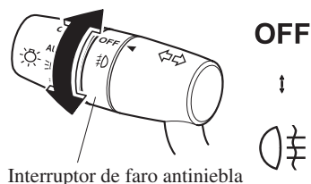
Interruptor de faro antiniebla
